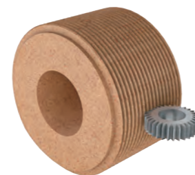
図34 連続創成式歯車研削の概略図
