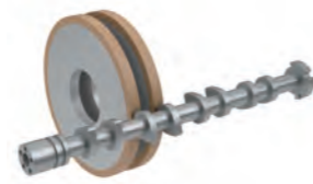
図10 カムプロファイル研削の概略図
