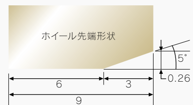
図9 試験用ビットCBNホイール先端形状
