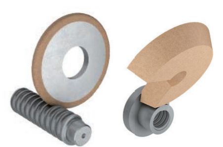
図5 ボールねじのねじ研削、外周・端面研削の概略図
