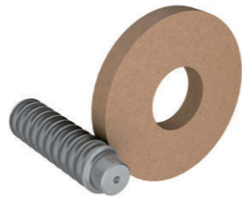
図1 ボールねじの外周研削の概略図
