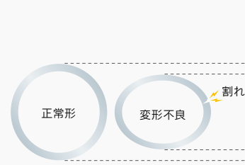
図8 薄肉ワークの変形と割れ
