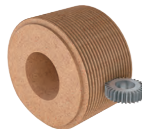
図34 連続創成式歯車研削の概略図
