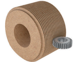
図12 連続創成式歯車研削の概略図
