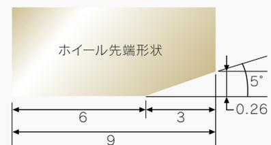
図10 コンタリング研削 試験方法
